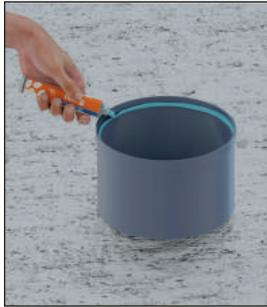
**Passo 2:** Faça o encaixe manualmente do prolongador na caixa de gordura com adesivo plástico Tigre, empurrando até encostar no fundo da bolsa.
