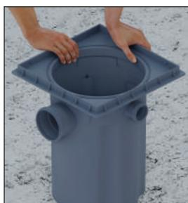
**Passo 2:** Aplique o adesivo plástico entre as partes (corpo e porta-tampa) e encaixe o porta-tampa manualmente até encostar no fundo da bolsa.
